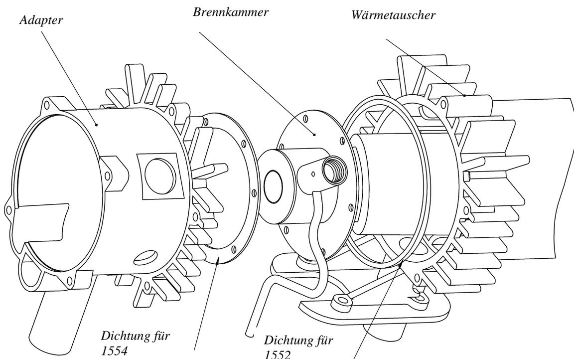
Abb.13 - Schema der Installation der Brennkammer in PLANAR-44D
