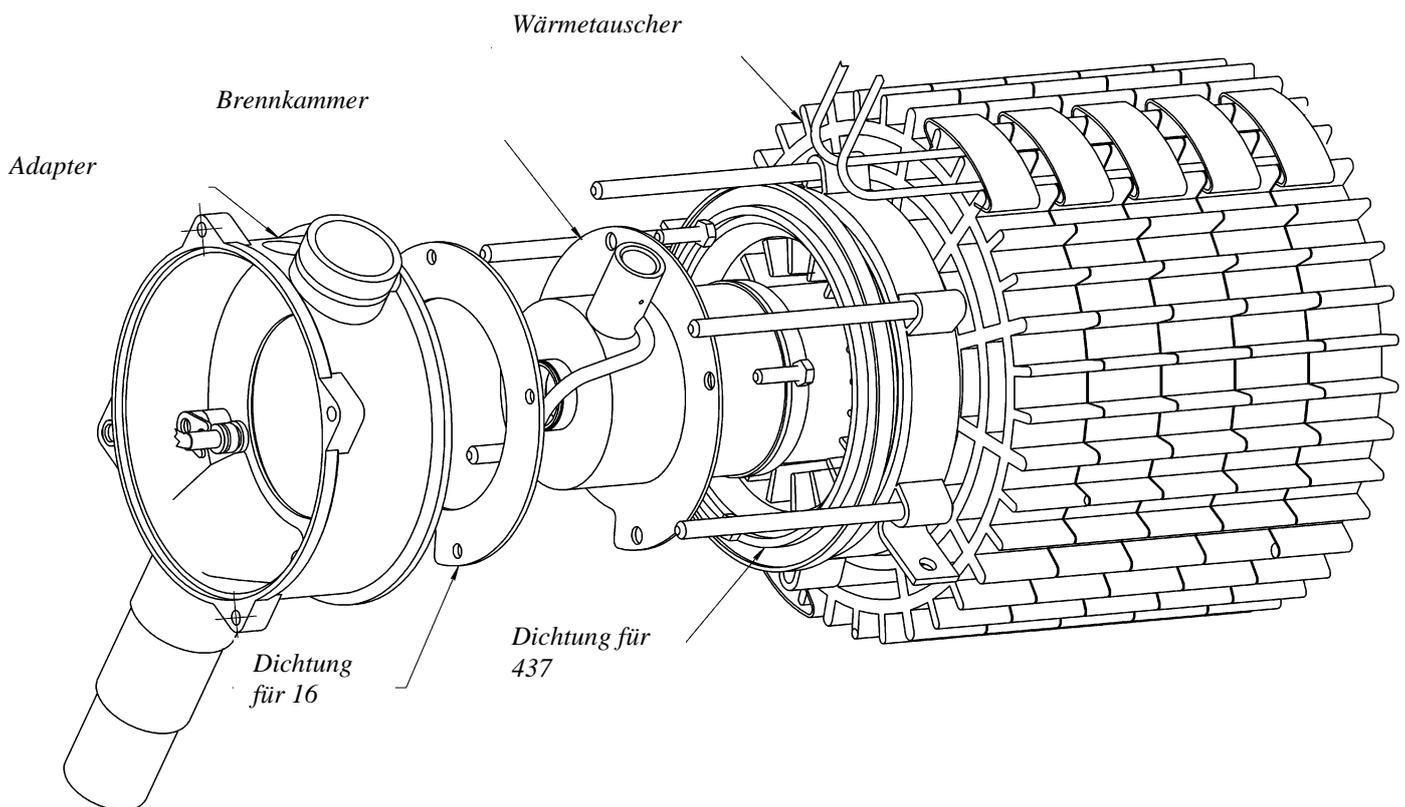
Abb.15 - Schema der Installation der Brennkammer in PLANAR-8DM.
