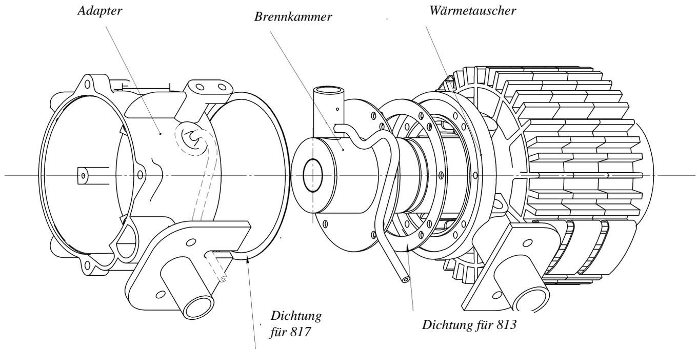
Abb.14 - Schema der Installation der Brennkammer in PLANAR-4DM2.
