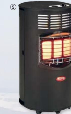
⑤ **Comfort Heater**, thermoelektrische Zündsicherung, Sauerstoffmangelsicherung, Piezozündung, Regelung in drei Stufen, mit Schlauch ohne Gasdruckregler. Leistung 4,2 kW / 50 mbar, Verbrauch 295 g/h, Maße ca. 75,5 x 38,5 x 43 cm (HxBxT), Gewicht ca. 15,5 kg. Art.-Nr. 080370 - € 174,95
