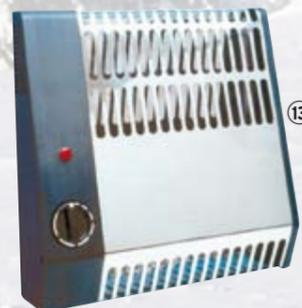
⑬ **Frostwächter FW 500**, Rohrheizstrahler aus Edelstahl, ideal für Toilettenräume, Wohnwagen, Gewächshäuser, Gartenhäuser bis 15 qm. Das Gerät hat autom. Temperaturregelung über Thermostat, Frostschutzschaltung mit Kontrollleuchte. Maße: H 24 x B 24 x T 11 cm. Gewicht: ca. 1 kg. Thermostateinstellbereich + 5° C bis 35° C. Art.-Nr. 080206 - € 29,50
